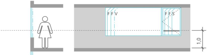
Règle du 1 mètre: protection anti-chute par verre feuilleté de sécurité (V) et protection des personnes par verre de sécurité (S)
