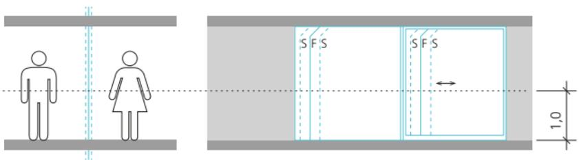
Règle du 1 mètre: protection des personnes par verre de sécurité (S); par ex. avec vitrages fixes, portes levantes et coulissantes, portes coulissantes et portes-fenêtres
